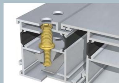
Stützbolzen mit Befestigungsplatte verschrauben (Spezial-Schraubendreher). Empfohlenes Anzugsmoment 12 bis max. 17 Nm. Der Bund stützt sich auf der Hauptkammer ab.
