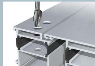
Bohrungen  $\varnothing$  11 mm mit Hahn-Zapfensenker auf  $\varnothing$  15 mm aufbohren. Hauptkammer nicht durchbohren.
