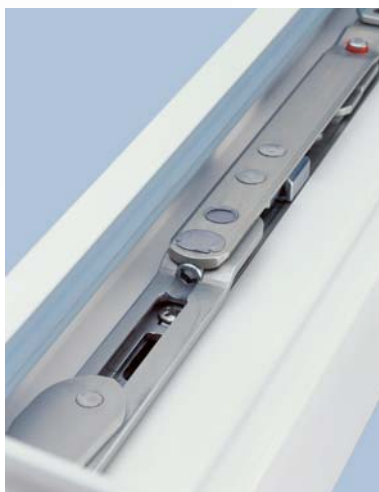
Eenvoudige afstelling van de speling van het raam met behulp van twaalfkantige stelschroef en 4 mm inbussleutel
