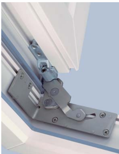
Afstelling in drie richtingen aan het hoekscharnier voor optimaal stellen van het raam in zijwaartse en verticale richting en afstellen van de aandrukkracht
